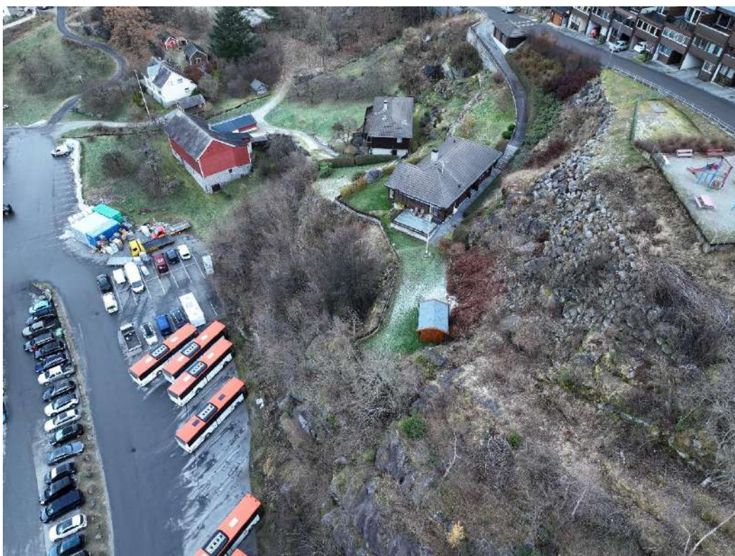
Figur 5-84: Dronefoto som viser fylling av steinmasser rett ovenfor bolighus.
