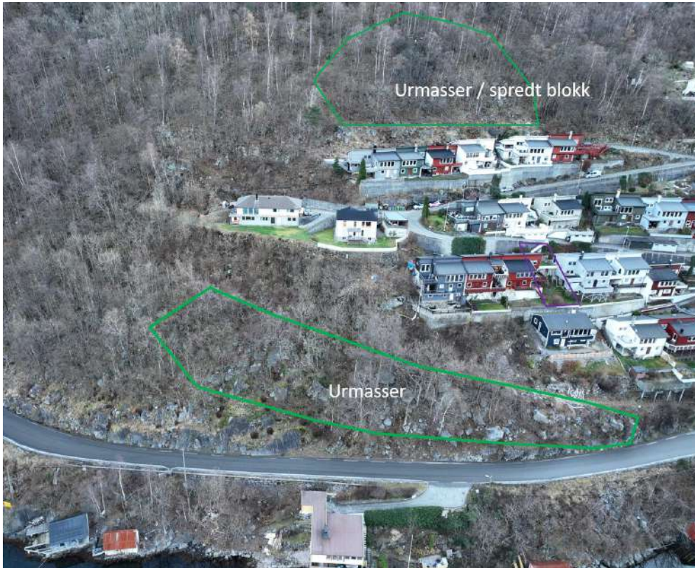
Figur 5-8: Dronefoto som viser avmerkede områder hvor det er observert urmasser ved Skogen boligfelt.
