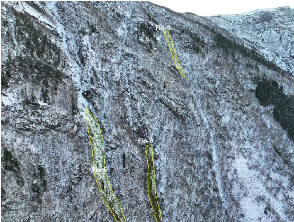
Figur 5-23: Dronefoto av gjelene tilknyttet løsnemrådene Flo-6 (Gudmundsjuvet), Flo-8 og Flo-9. Det er urmasser med varierende blokkstørrelser i gjelene, fra omtrent knyttnevestørrelse til 3 kubikk.
