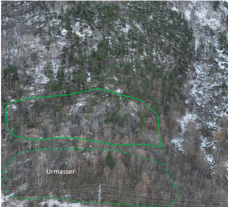
Figur 5-2: Dronefoto som viser løseområde ovenfor mastetrasé og med urmasser nedenfor. Bergmassen er forholdsvis kompetent og grovblokkig, med hovedsakelig 3 sprekkesett. Det er mindre partier i løseområdet som er mer småfallent og avløste blokker.
