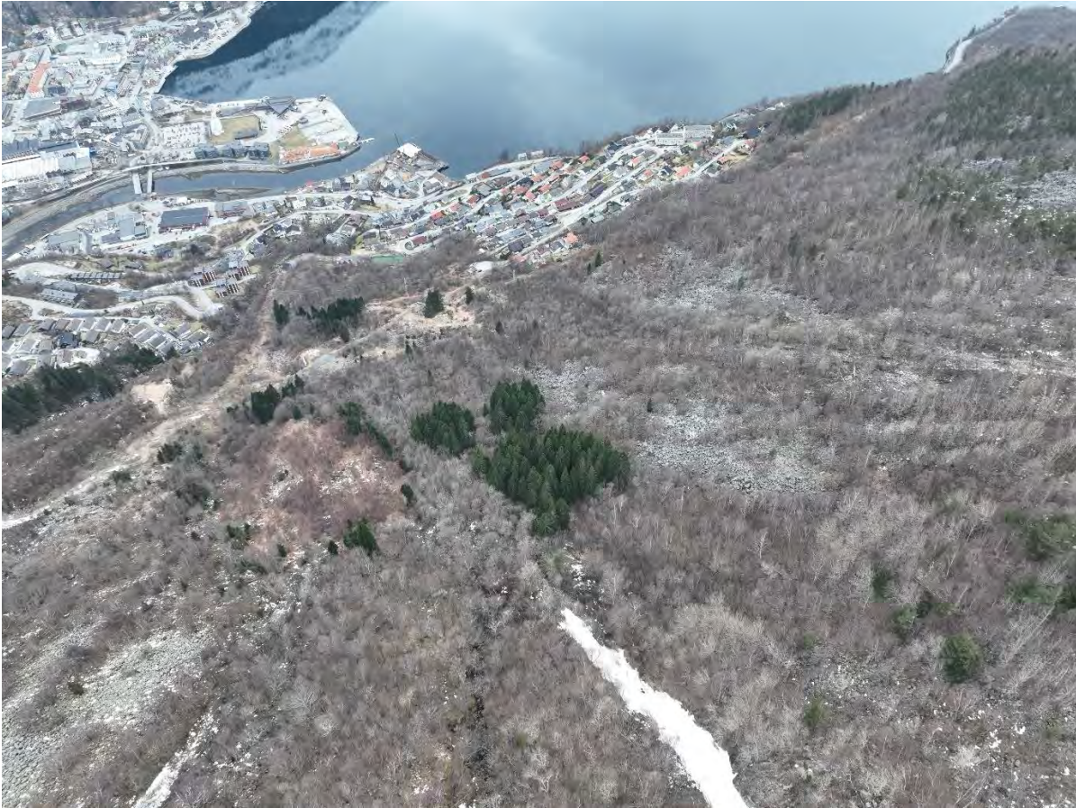
Figur 5-27: Dronefoto som viser snøskredavsetning ned fra Gudmundsjuvet og steinsprangavsetninger mellom Mjølstøkvitlet og Stølsia.
