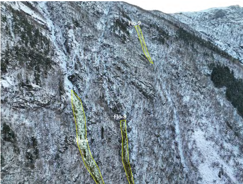
Figur 5-23: Dronefoto av gjelene tilknyttet løsneområdene Flo-6 (Gudmundsjuvet), Flo-8 og Flo-9. Det er urmasser med varierende blokkstørrelser i gjelene, fra omtrent knyttnevestørrelse til 3 kubikk.
