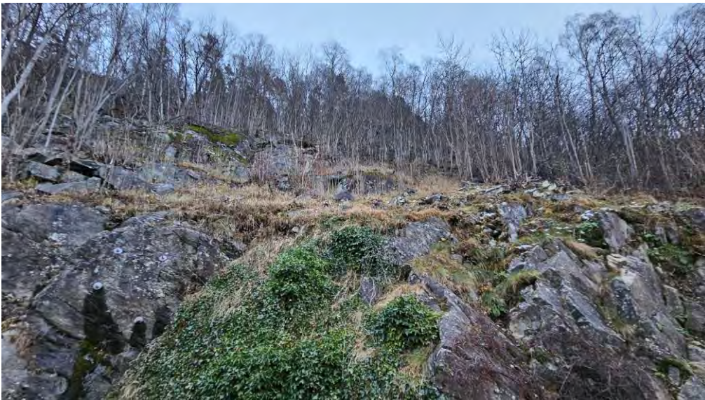
Figur 5-5: Infopunkt 75. Terrenget nedenfor Stp-1 med sporadiske blokker i fjellsiden. Det ble observert boltede blokker oppe i fjellsida. Bergmassen er forholdsvis kompetent med hovedsakelig 3 sprekkesett og noe varierende sprekkeavstand. Noe kortere sprekkeavstand i Stp-1 sammenlignet med Stp-2 og Stp-3.
