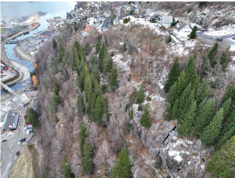
Figur 5-63: Dronefoto over fjellsiden ovenfor Lothepus Camping. Det er observert steinsprangavsetninger på hyllene og avløste blokker i fjellsiden.
