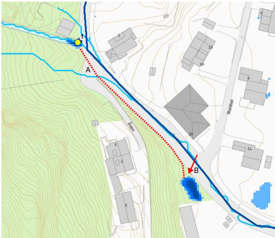
Figur 40: Foreslåtte tiltak ved Rødna/Malthøl for å tilrettelegge for flomvei tilbake til åpen kanal.
