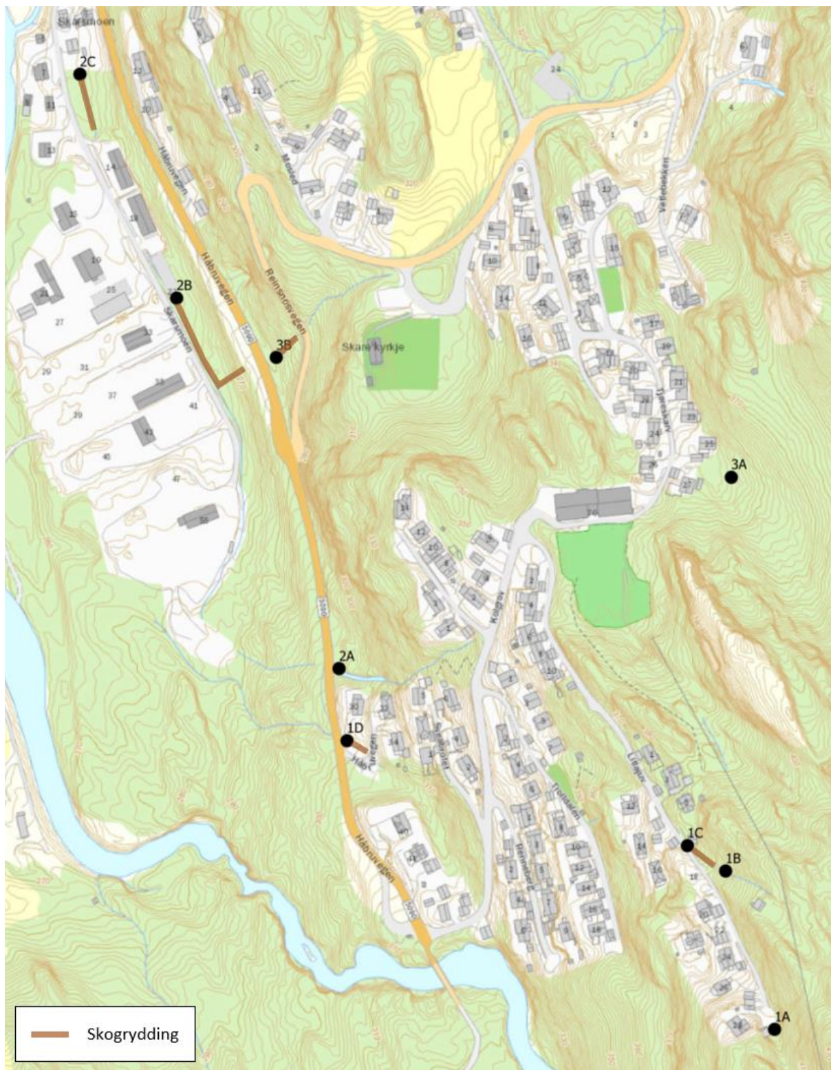
Figur 9: Strekninger identifisert som aktuelle for skogrydding i Skare
