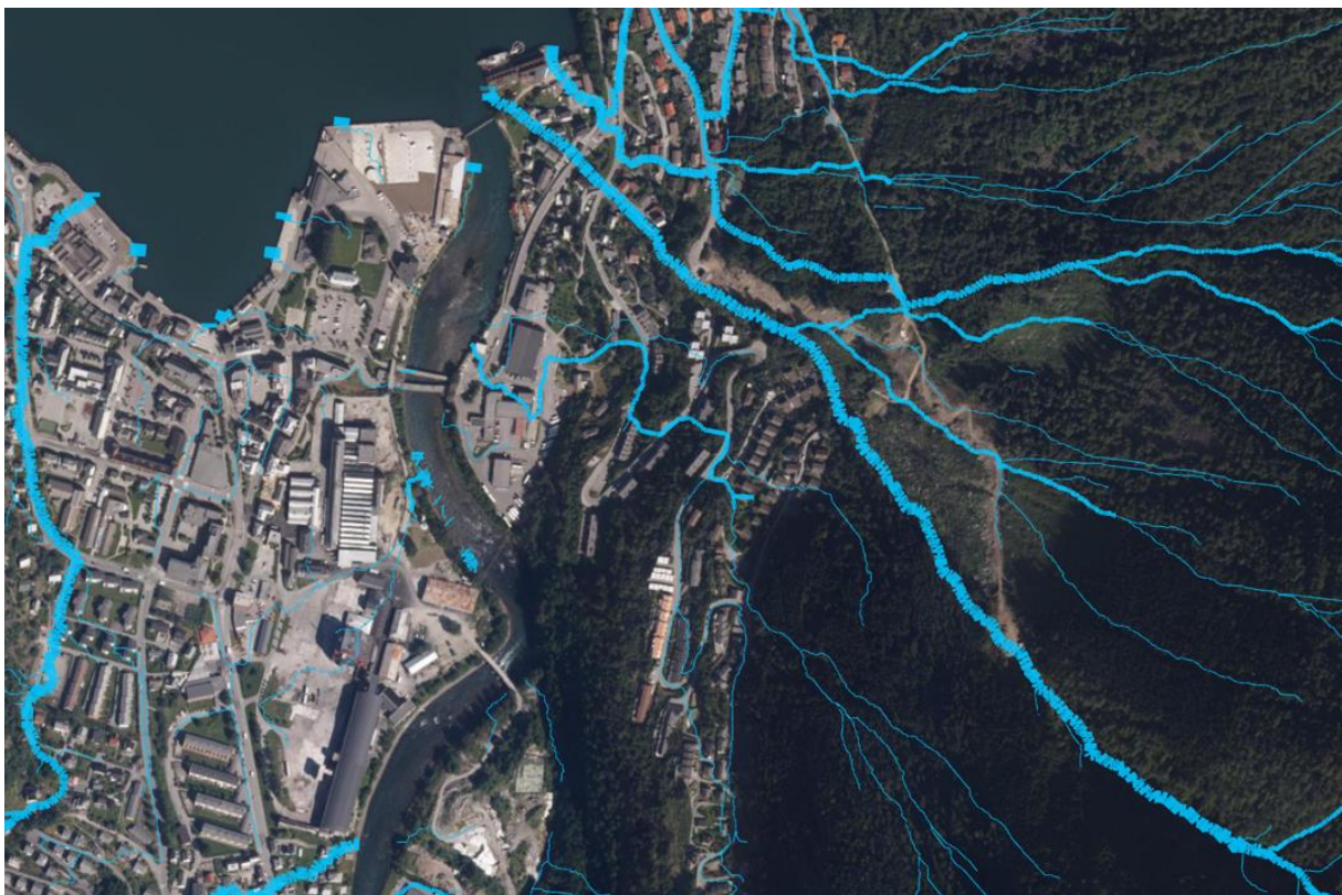
Figur 23: Eksempler på genererte avrenningslinjer i Odda sentrum. Tykkelsen på linjen korrelerer med tilknyttet nedbørfelt.
