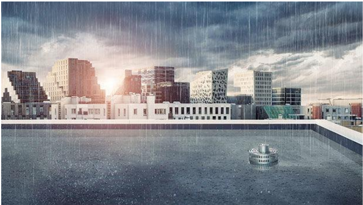
Figur 16: Illustrasjon av blå tak. Taknedløpet strupes slik at taket fungerer som fordrøyningsmagasin (illustrasjon: Protan)
