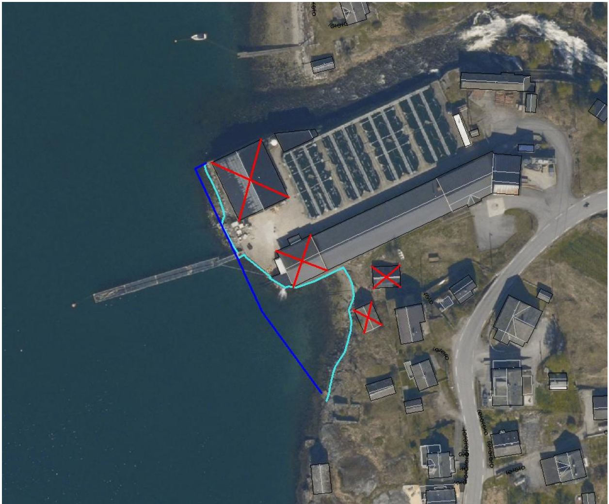
Figur 4 - Illustrasjon som viser ny kystlinje i forhold til dagens, og kva bygningar som er planlagt rivne, kjelde: Omega Visualiseringane under viser planlagt utbygging. Med bakgrunn i dette er det gjort nokre endringar på plankart og i føresegnene.
