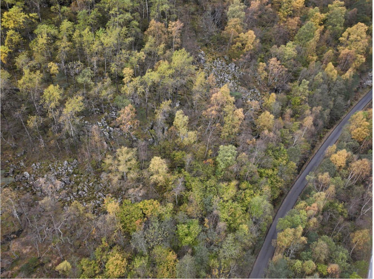
Figur 32 – Dronebilde av nordvestlig del av kartleggingsområdet. Veien på bilde går parallelt med fjorden. Bildet viser steinsprangavsetninger på oversiden av veien.
