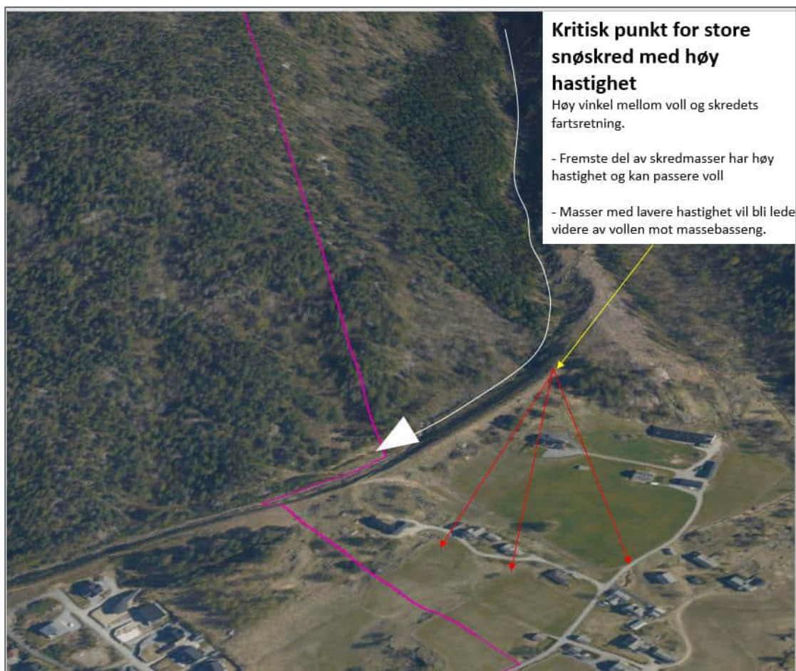
Figur 46 – Illustrasjon som viser svakt punkt langs skredvollen ved Giljabekken.
